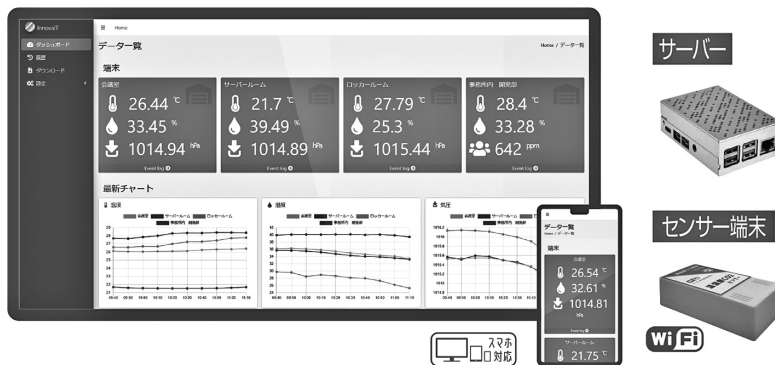
図1 温湿度管理システムのサーバーおよび温湿度センサー端末
