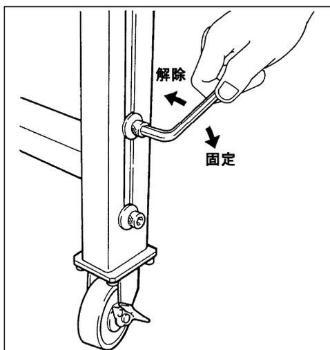
各キャスター上部（2本×4～6ヶ所）に付いている高さ調整ボルトを六角レンチで緩めコンベアベルトの高さを調整します。
