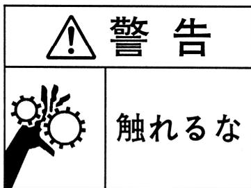
保守目的、その他の理由で動作範囲で作業を行う場合に、モーター・回転軸・歯車・プーリー・ベルト等に巻き込まれる危険のある部分に不用意に手を触れないでください。作業を行う場合は、電源を遮断して行ってください。
