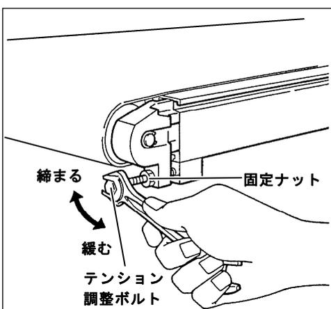
搬入側の両側にあるテンション調整ボルトを調整してベルトの張りを調整してください。
