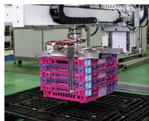
樹脂コンテナ搬送
