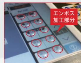
タッチパネル上の保護シート(フリー操作キー表示部)にエンボス加工を施しました。タッチ感があるのでペンダントの誤入力を防止できます。
